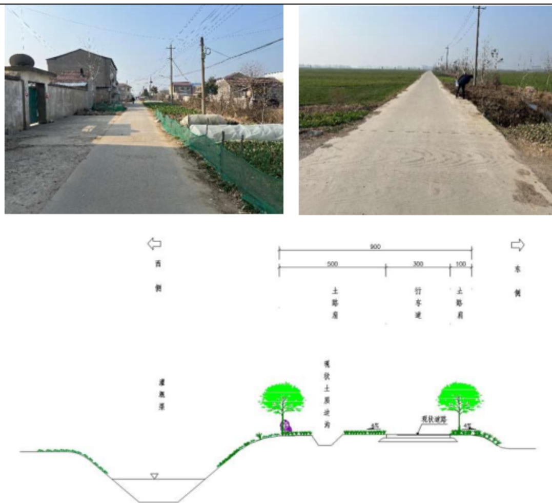
图 2-1 项目村道现状及路基断面
