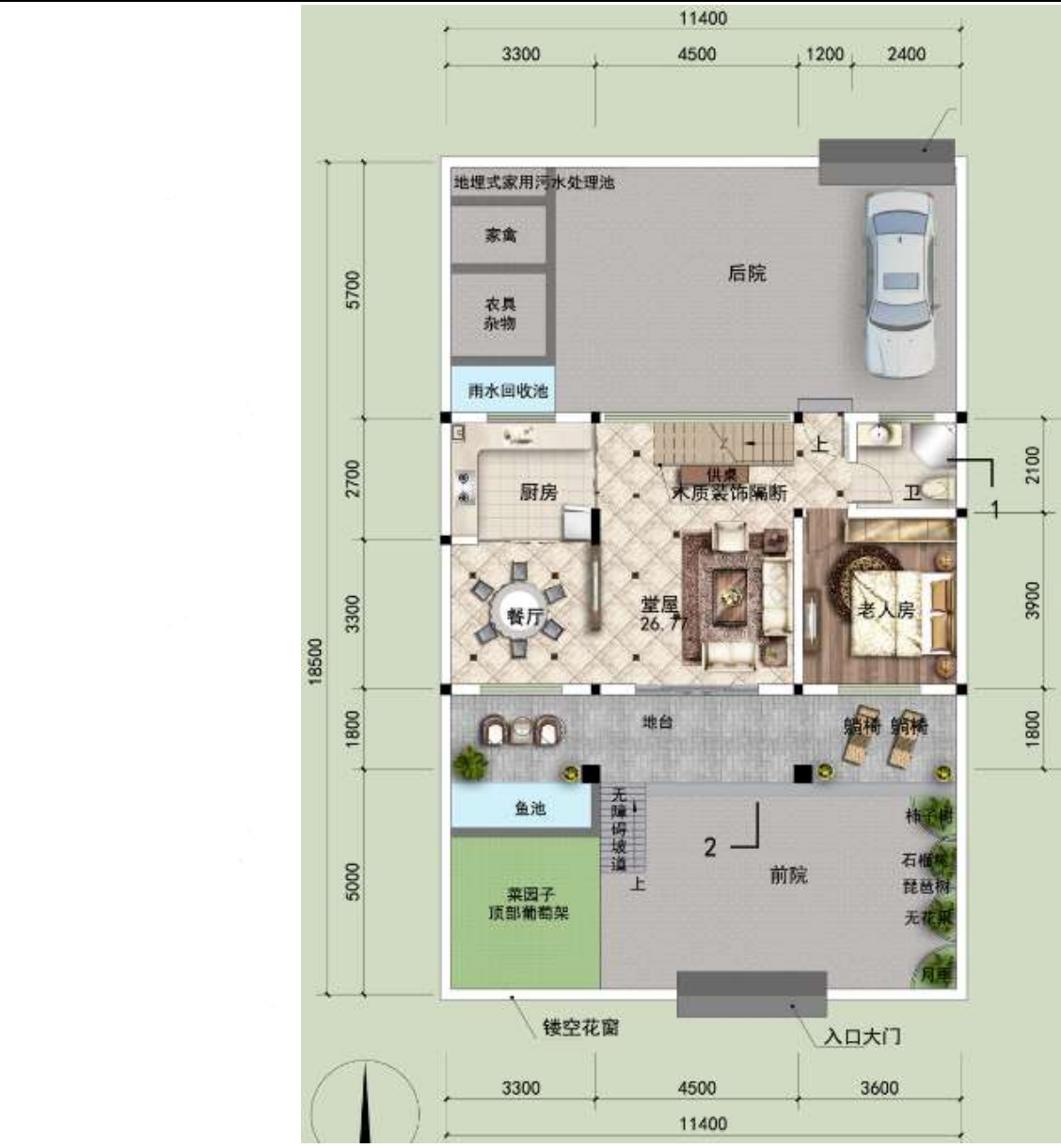
一层平面图 (面积: 73平方米)
